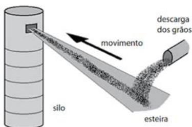
Nesse processo de eletrização, os grãos e a esteira ficam carregados com cargas elétricas de sinais
